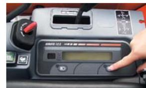
1 Stecken Sie den roten Schlüssel in das Zündschloss und drücken Sie anschließend den rechten Menüschalter mit dem Bildschirmsymbol.
