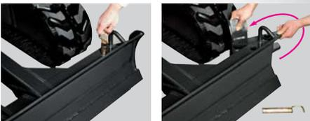
Durch die einfache Demontage von jeweils einem Verriegelungsbolzen, werden die nach innen einklappbaren Seitenteile des Planierschild, entsprechend der Fahrwerksbreite angepasst.
