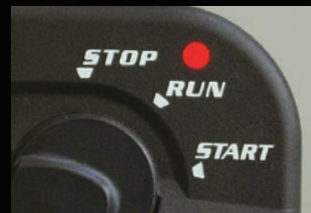
LED – Warnanzeige bei aktiviertem Diebstahl - System
