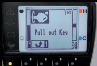
Informations – Alarm bei im Zündschloss befindlichen Schlüssel
