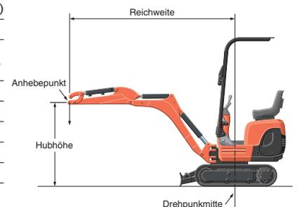
\* Die technischen Daten über den Arbeitsbereich der Maschine wurden mit dem Kubota Standard - Tieföffel ermittelt, ohne Schnellwechseleinrichtung.
